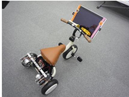
図 2: 三輪車型操作インターフェース
