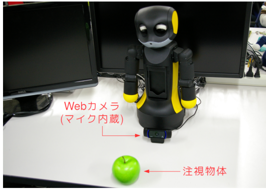
図 3: 実装されたロボットが物体を注視する様子
