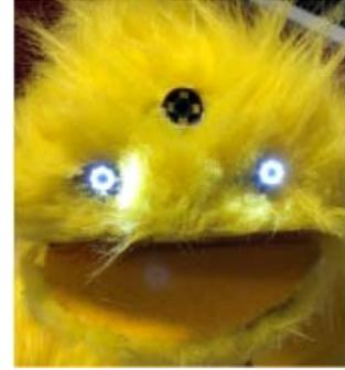
図 14: Prefer の顔部分. 点灯しているカメラの映像に YOLO を用いる. 点灯していないカメラの映像には OpenCV のみを用いる.
