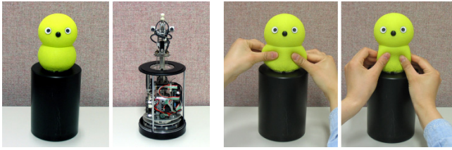
図 3 Keepon の構造：外見と内部構造（左），外皮のやわらかさ（右）。
