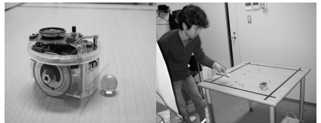
図 1. 左図に実験に用いられた小型ロボット e-puck を示す。右図は実験風景である。
