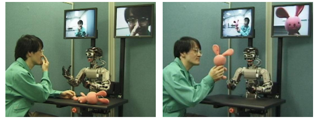
図1 子ども型ロボット Infanoid (アイコンタクトと共同注意) Fig.1 Infanoid, performing eye-contact and joint attention.
