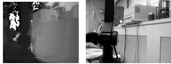
図 3: 三次元距離センサーの測定値 (左) 同時に CCD カメラの画像 (右)
