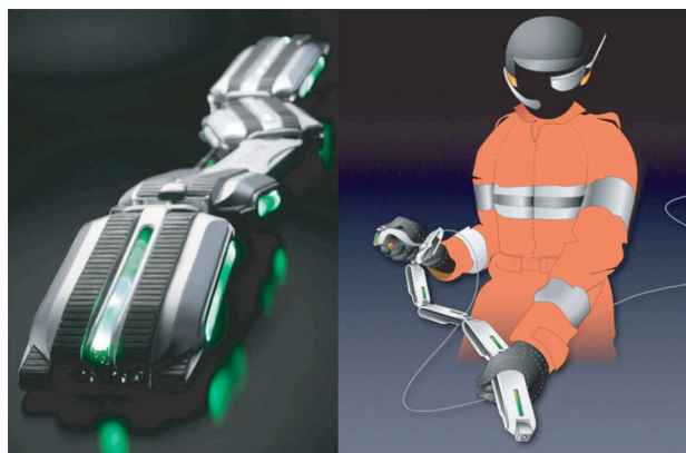
図 7: レスキューロボ MOIRA03 (左) と操作リモコン (右)
