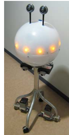
図 1: だるまさんがころんだをプレイするロボット。筐体内の LED を点灯した状態。
