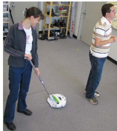
図 4: 直接ロボットを動かすシステムの概観。アルミニウムの棒を持ちいたロボットインターフェースで人を追いかける動作を作成しているところ。
