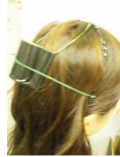
図 1: 後頭部に装着された加速度センサー
