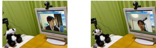
図 4: 左:カメラ切替無, 右:カメラ切替とフォロー動作
