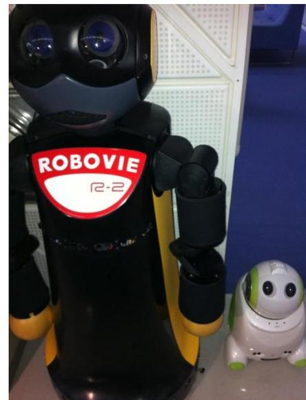
図 2: 使用したロボット (左: Robovie-R2, 右: PaPeRo)
