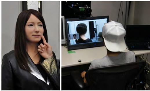
図 1: (左図) 遠隔操作型アンドロイドージェミノイド (右図) 遠隔操作の様子
