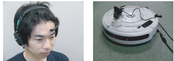
図 2: NeuroSky Mindset を装着したユーザ (左)、Web カメラを搭載した Roomba530 (右)
