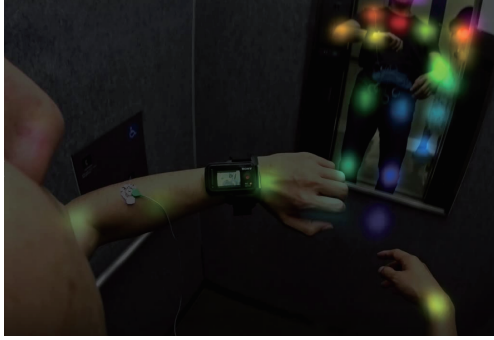
図 5: Sensoroid を装着して鏡を見ているシーン. 図中の色がついている部分は, 身体パーツ検出による候補点を示している.
