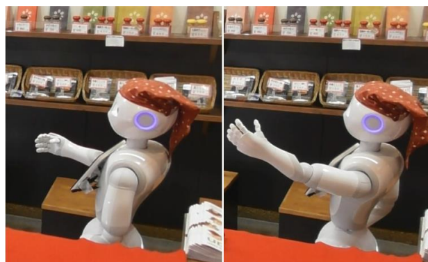
(a) 握手を求める動作 (b) 試食を提案する動作 図 4 ロボットの動作
