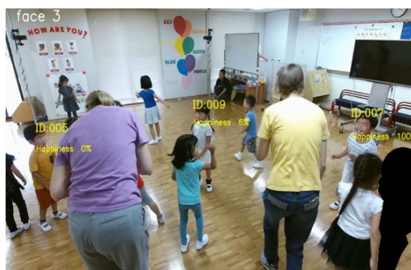
図 4: OKAO Vision による表情検出と個人識別.
