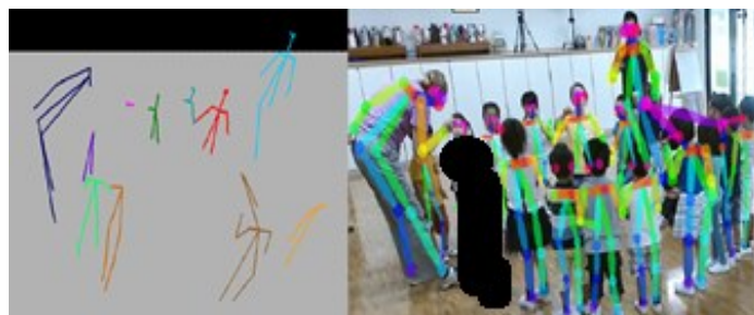
図 3: OpenPose による骨格の検出と(右), 三角法による 3D 空間への投射(左).
