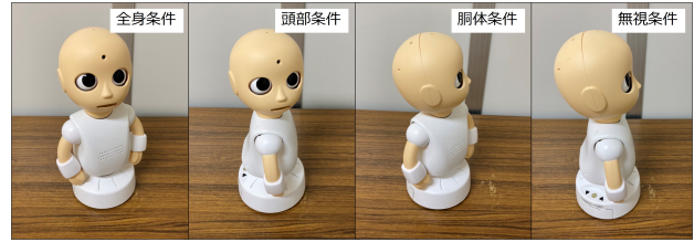
図 10: ロボットの身体ねじり
