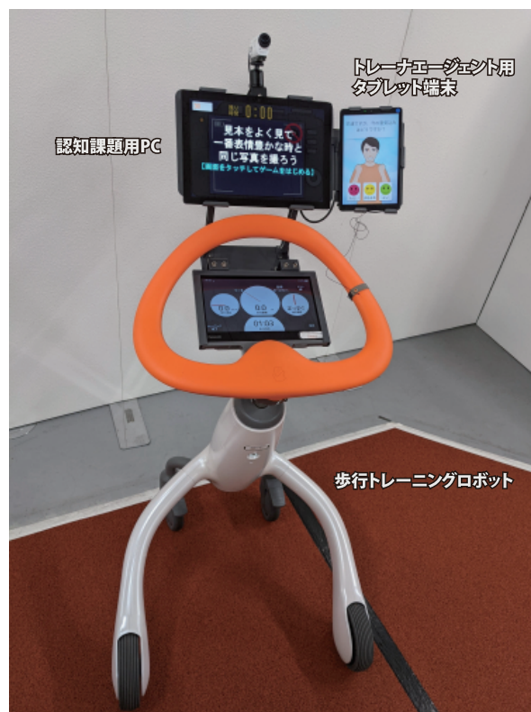
図 1: 認知課題表示用 PC とトレーナエージェント用タブレットを取り付けた歩行トレーニングロボット
