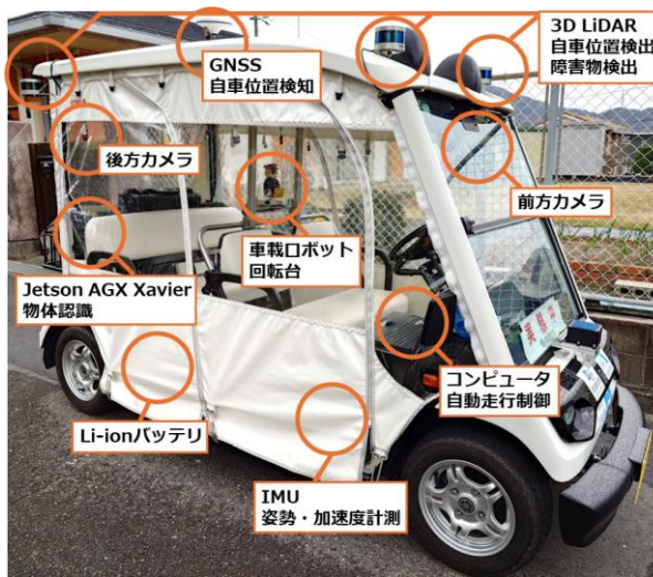
図1. 自動運転車両の構成（ゆっくりカート）
