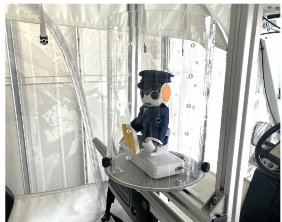
図3. 車載ロボットの設置
