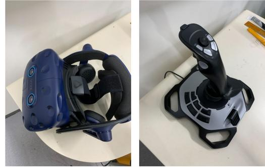
(a) 実験で使用したヘッドマウントディスプレイ (b) 実験で使用したジョイスティック
