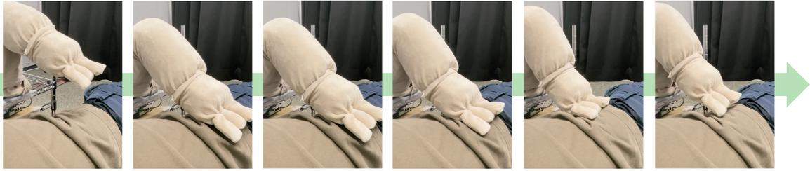
図 7: 予備実験で使用した撫で（指の稼働なし）のモーション
