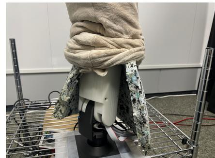
図 3: 開発した接触型ロボットの構造。内側から 3D プリンタで作成されたフレーム、ウレタンチップスポンジ、布生地で構成されている。
